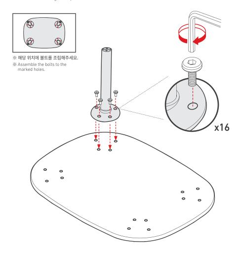
1 조립 홈에 다리를 맞추어 볼트를 끼운 후 렌치로 조여주세요. Match the legs with the holes and tighten bolts with the wrench.
